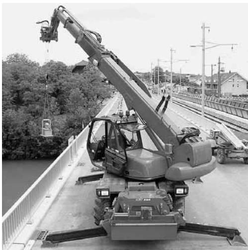
Illustration 5 (camion-grue): chariot élévateur télescopique équipé de treuil à câble.
