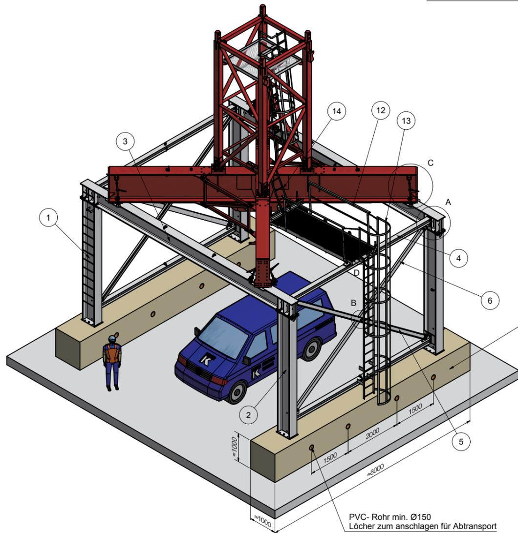
Die bauseitige zu erstellende Kranfundation ist so zu gestalten dass sie den auftretenden Belastungen (Eckdrücke, Schubkräfte, etc.) sowie den verkehrsbedingten Aufprallkräften standhält.
