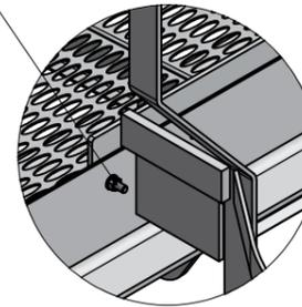
2 Stk Maschinenschrauben 8.8 M20x70 mit Polystoppmutter
