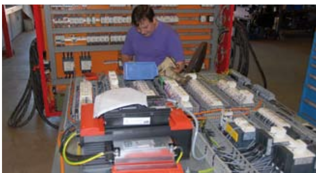
Neuaufbau von Elektromechanik und Frequenzumrichter.
