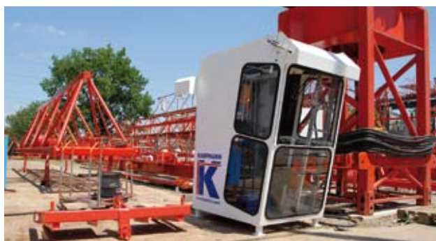
Neue Krankabine mit neuem ergonomischem Steuerstand.
