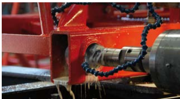
Aufarbeiten der Bolzenverbindungen mittels Schweisroboter und anschliessendes Bearbeiten auf Originalmass.
